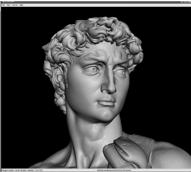
Figura 7. Visualizador interactivo desarrollado por la "Stamford University" en el ámbito del "Digital Michelangelo Project" en el que es posible interaccionar con el levantamiento escáner láser del David (aplicación ScanView 1.21 desarrollada por Stamford Computer Graphics Laboratory, http://graphics.stanford.edu/software/scanview/ )
