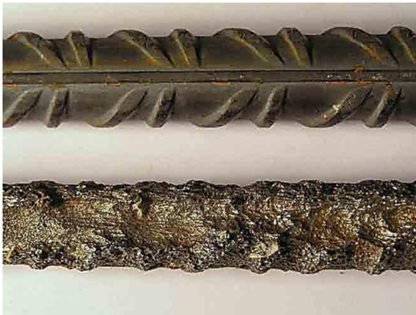
Figura 1: barras con y sin corrosión
