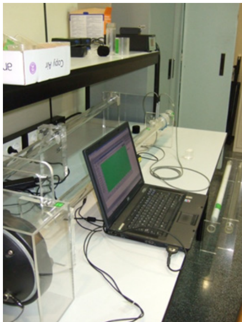
Figura 3 dispositivo de medida del coeficiente de absorción en incidencia normal según UNE EN 10534-2:2002
