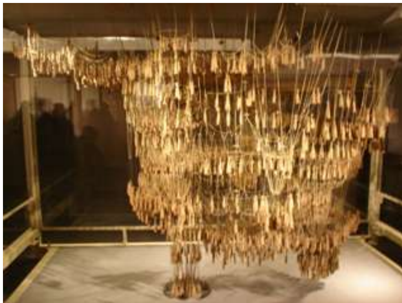
Fig. 49. Maqueta invertida creada por Antonio Gaudí con saquitos de perdigones para nivelar los pesos. Maqueta para la Sagrada Familia.
