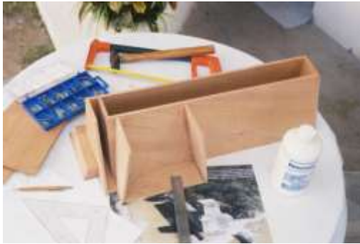
Fig. 67. Levantamiento de volúmenes clavados y pegados con pegamento blanco de alta resistencia
