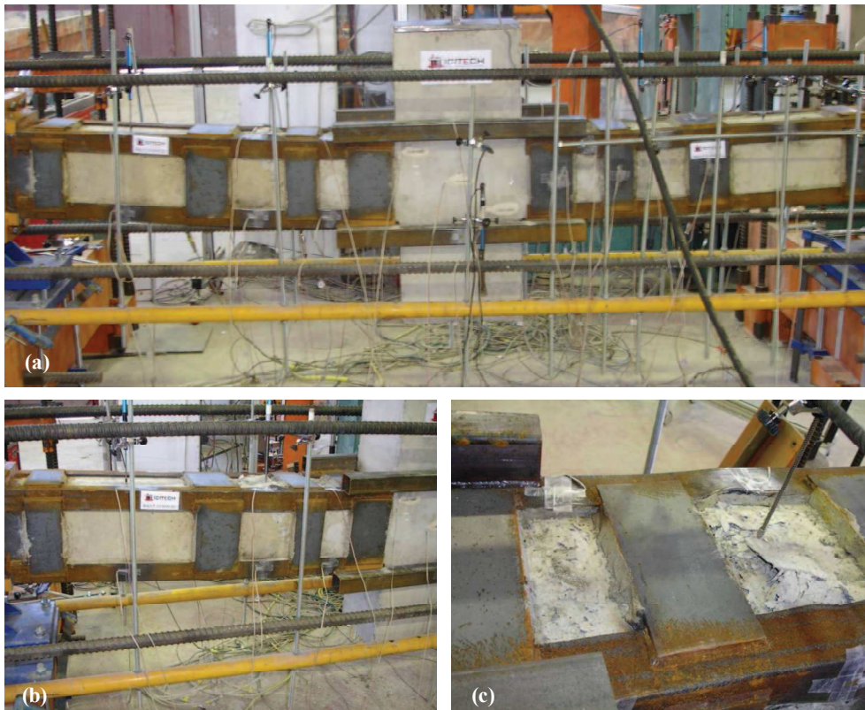
Fig. 3.19. Rotura de las probetas T-1000; (a) Vista general; (b) Zona donde se produce el agotamiento del soporte reforzado; (c) Detalle del agotamiento del hormigón en la cara comprimida.
