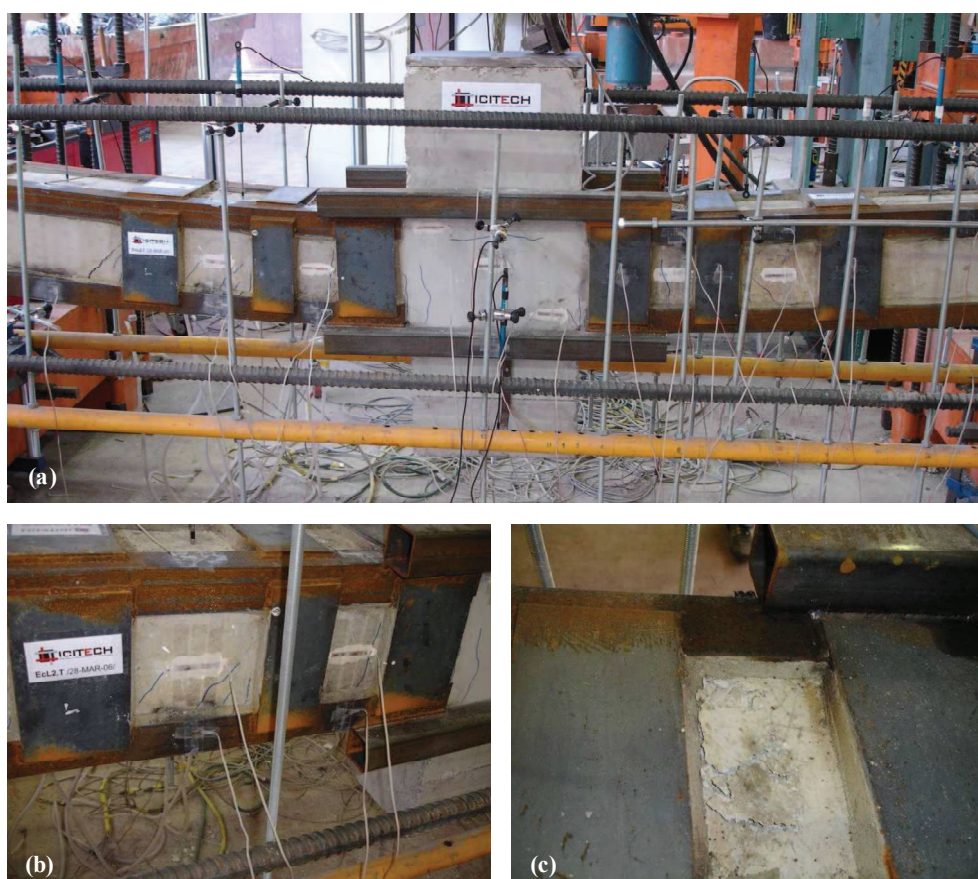
Fig. 3.18. Rotura de las probetas T-300; (a) Vista general; (b) Fisuración aparecida en el soporte reforzado debida a los esfuerzos de tracción; (c) Detalle del agotamiento del hormigón en la cara comprimida.
