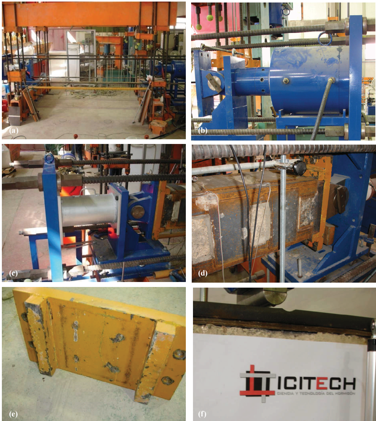
Fig. 3.17. Pórtico de ensayos: (a) Vista general; (b) Detalle del apoyo móvil con la prensa horizontal; (c) Detalle del apoyo fijo; (d) Unión de la probeta con el pórtico de ensayos; (e) Pieza metálica para la conexión de la probeta con el pórtico; (f) Neopreno y placa de reparto para conseguir una buena introducción de la carga vertical, perpendicular al eje del soporte.
