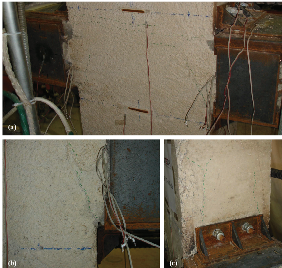
Fig. 3.27. Rotura de las probetas B-800; (a) Vista general; (b) Fisuración en la zona traccionada en el entronque del soporte con el nudo viga-soporte; (c) Zona en compresión, capitel aplastando el hormigón del nudo.
