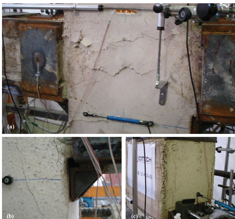
Fig. 3.23. Rotura de las probetas A-800; (a) Vista general; (b) Cono de arrancamiento en la zona de entronque del soporte con el nudo viga-soporte y ligero despegue del capitel; (c) Zona en compresión, capitel aplastando el hormigón del nudo.
