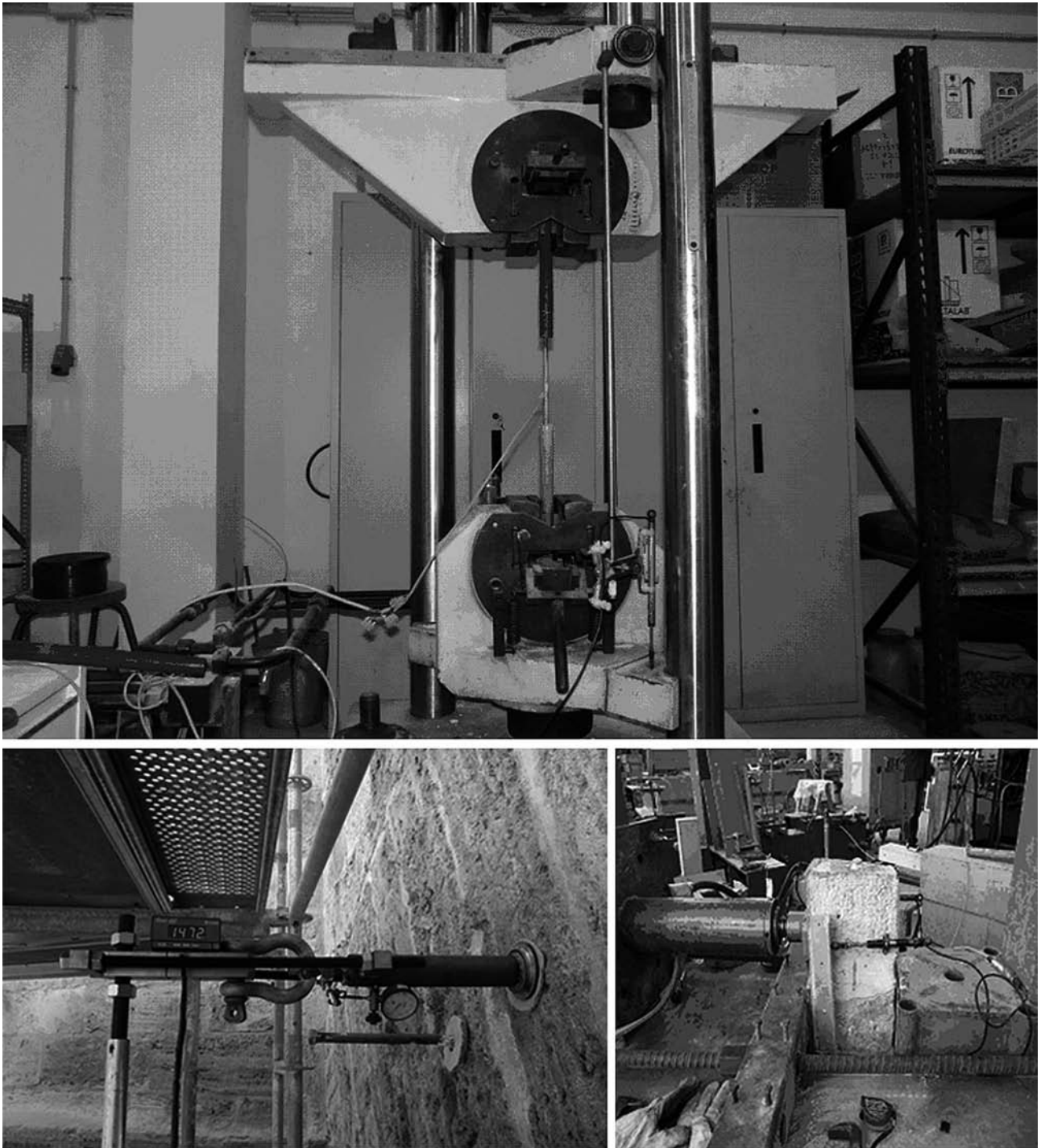
Figura 3. Ensayos de tracción de la varilla; de Pull-Out y de corte del anclaje.
