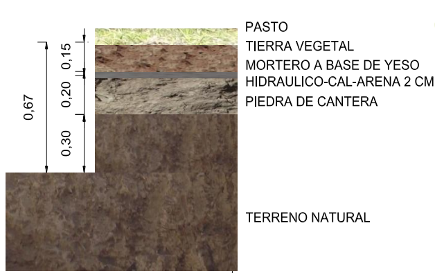
Figura 3.3.8. Resultados la estratigrafía de la cala C4 Figura 3.3.9 Representación en detalle tridimensional.
