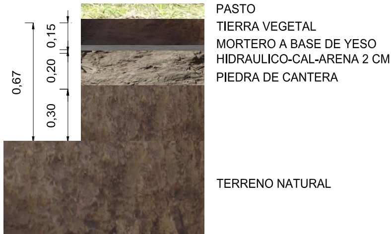
Figura 3.1.40. Muestra de resultados la estratigrafía de la cala C2
