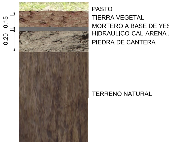
Figura 3.2.66. Muestra de resultados la estratigrafía de la cala C7
