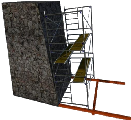
Figura 3.4.24. Detalle montaje andamio para dar una pendiente.
