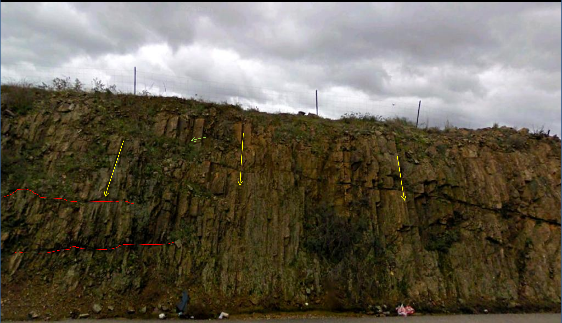
Familias de discontinuidades en las pizarras y areniscas del Ordovícico Med.-Sup. Al S de Castuera, SE Hoja. Badajoz.
