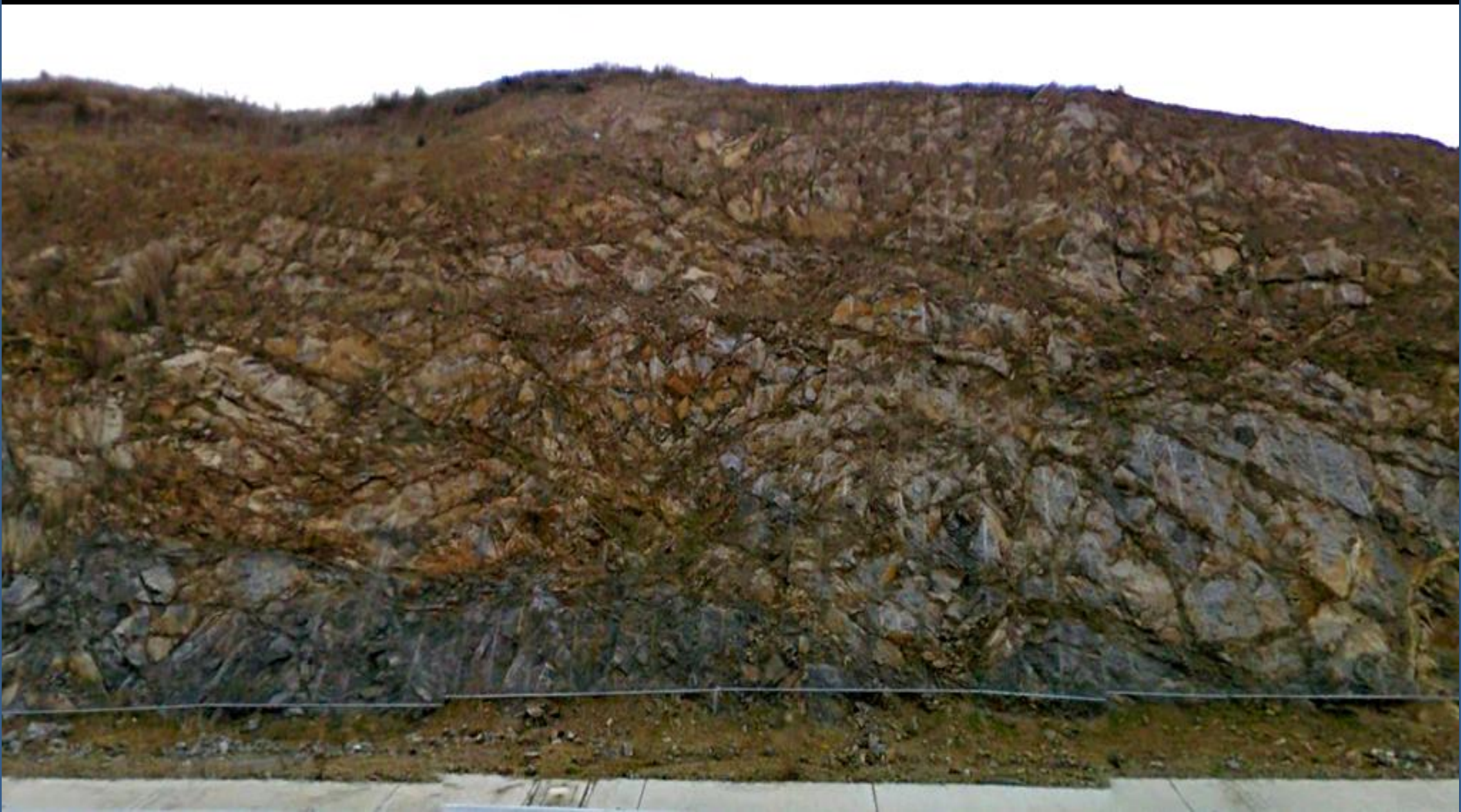
Granitos de dos micas tectonizados. Autovía en el E de Oliva de Plasencia. NW Hoja de Plasencia, Cáceres.
