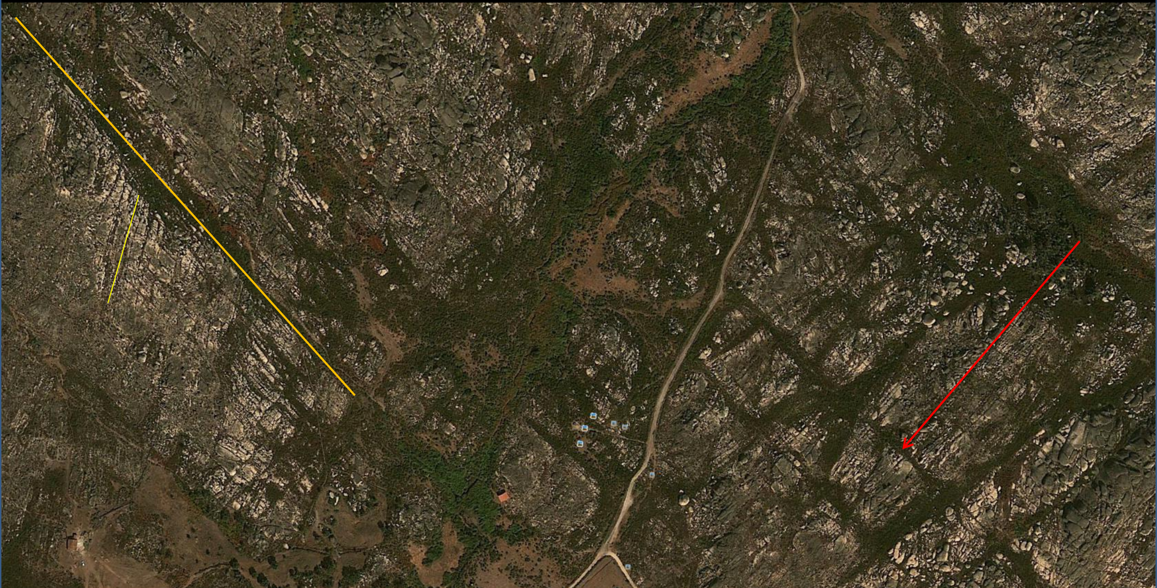
Familias de planos de disyunción en masas de granitos de dos micas porfiroides. S de Valencia de Alcántara, Cáceres. NE Hoja de Pino de Valencia.
