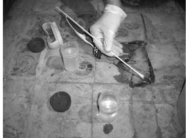
Figura 2. Limpieza físico-mecánico con cepillos de dureza blanda e hisopo
