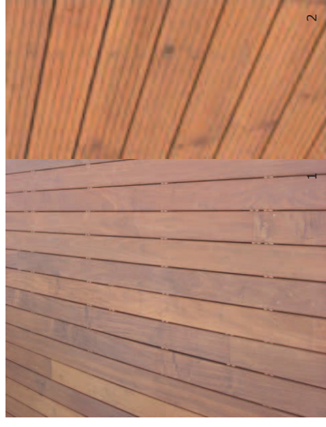
1. Madera ipé/ 2. Madera de Bangkirai/ 3. Detalle protección solar tipo brise-soleil horizontal de lama de madera ipé orientable tipo Llambi / 4. Parador Nacional de Turismo Luis Vives en El Saler de Valencia, Jose María Canosa y Fernando Martínez Hoz
