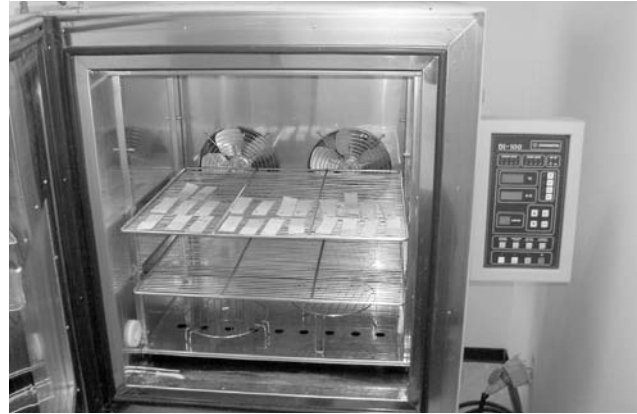
Figura 8. Probetas de soportes en el interior de la cámara climática
