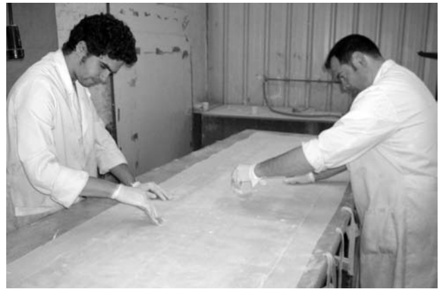
Figura 8. Proceso de tratamiento del reverso con una masilla a base de resina epoxídica
