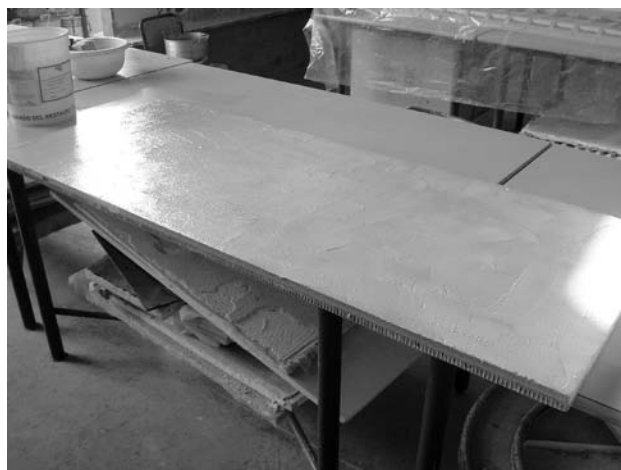
Figura 10. Nuevo soporte con núcleo de aluminio en forma de nido de abeja
