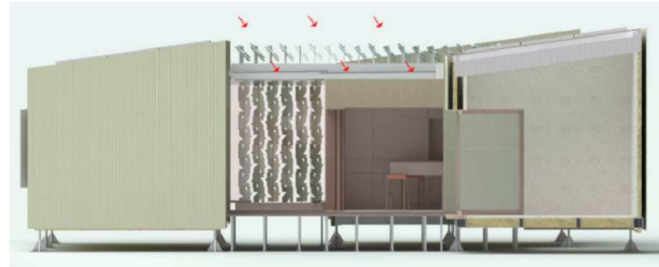
Cubierta de lamas de parra abierta para crear el efecto invernadero
