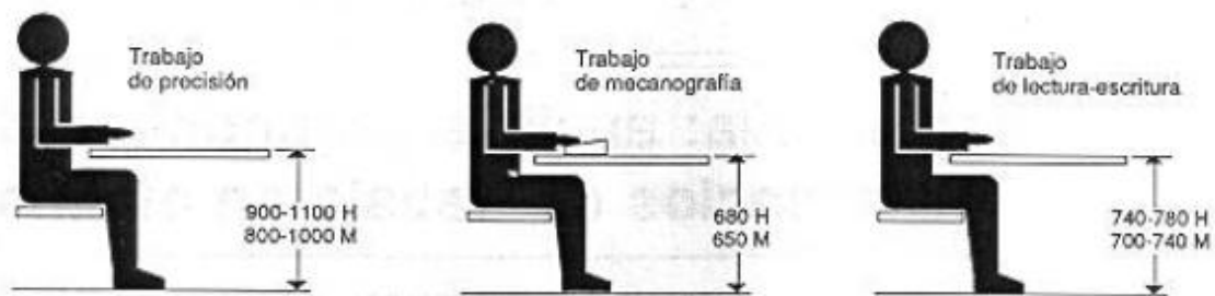
Figura 12: Altura del plano de trabajo para puestos de trabajo sentado (cotas en mm) (NTP 242)
