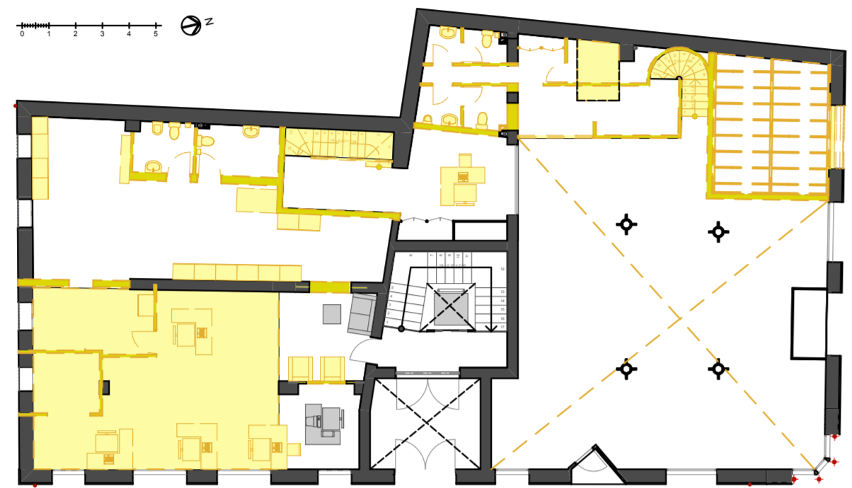
Demoliciones. Planta Altillo 1:200
