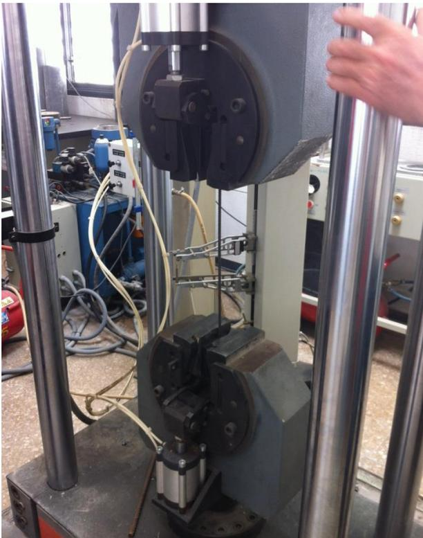
Imagen 27. Ensayo de tracción del acero
