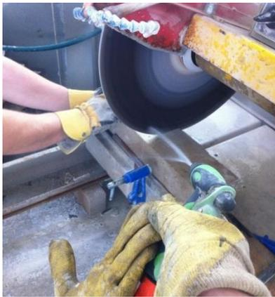
Imagen 66. Realización entalla probetas prismáticas
