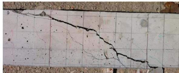
Imagen 126. Rotura viga V.1.5
