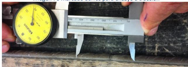
Imagen 77. Medición tras el ensayo de tracción
