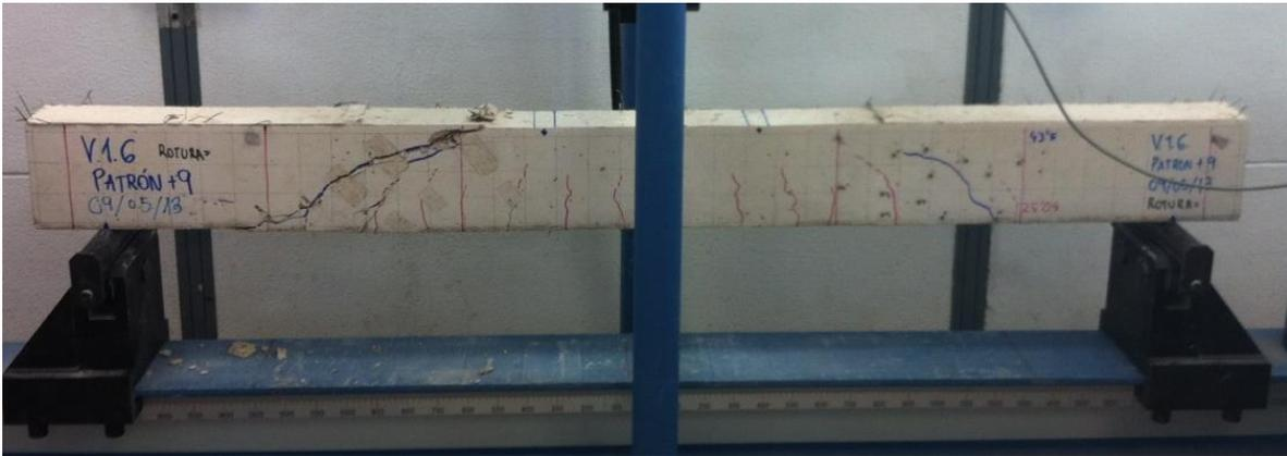
Imagen 127. Viga V.1.6 tras ensayo flexión a 4 puntos
