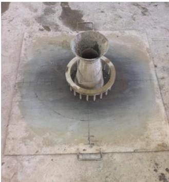
Imagen 52. Instrumentos para el ensayo de anillo J
