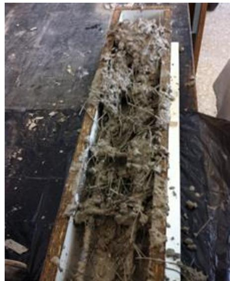
Imagen 115 Puesta en obra con 12,4 kg/m<sup>3</sup> de fibras
