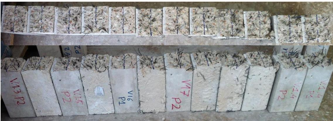
Imagen 118 cantidad de fibras en probetas prismáticas
