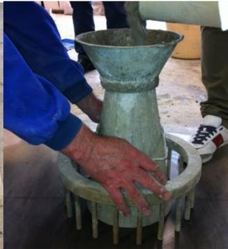
Imagen 53. Proceso ensayo anillo J
