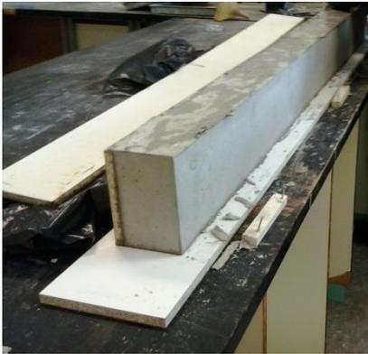
Imagen 62. Desencofrado viga
