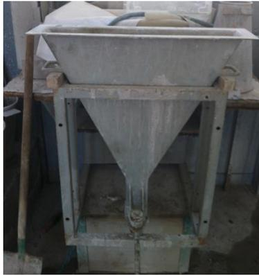
Imagen 55. Instrumentos para el ensayo del embudo en V
