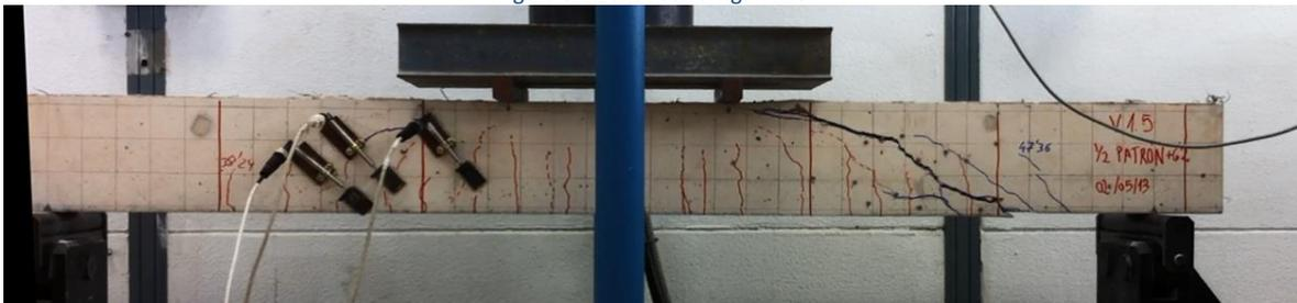
Imagen 125. Viga V.1.5 tras ensayo flexión a 4 puntos
