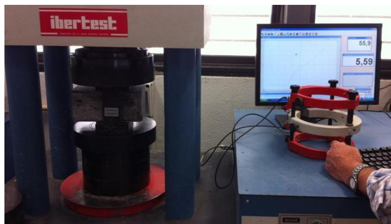
Imagen 69. Ensayo compresión probeta prismática
