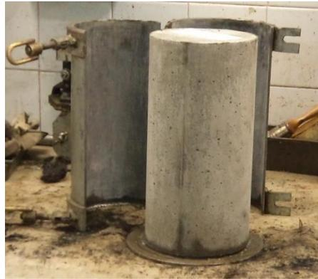
Imagen 63. Desencofrado probeta
