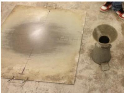
Imagen 49. Instrumentos para el ensayo de escurrimiento
