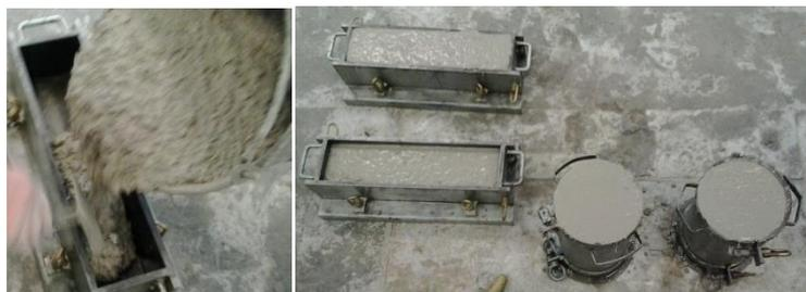
Imagen 60 y 61. Hormigonado de probetas
