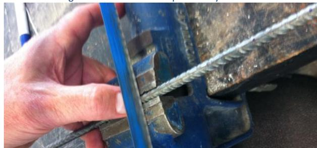
Imagen 76 marcado barras para ensayo a tracción
