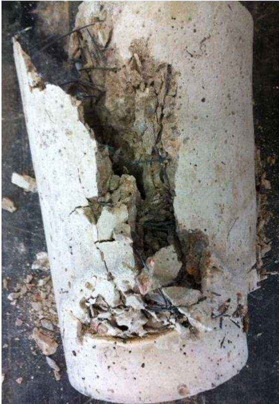
Imagen 119 cantidad de fibras en probetas probeta cilíndrica
