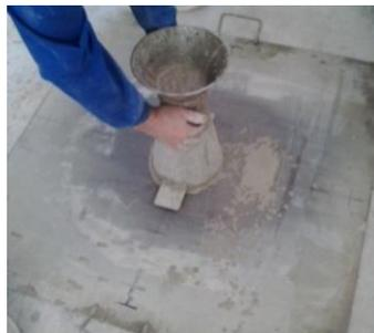
Imagen 50. Proceso ensayo de escurrimiento
