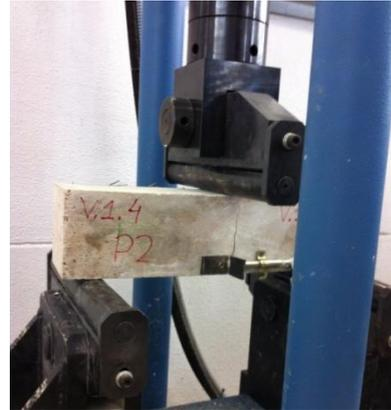
Imagen 68. Ensayo flexión en probeta prismáticas
