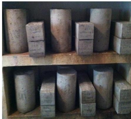
Imagen 65. Probetas en cámara de curado
