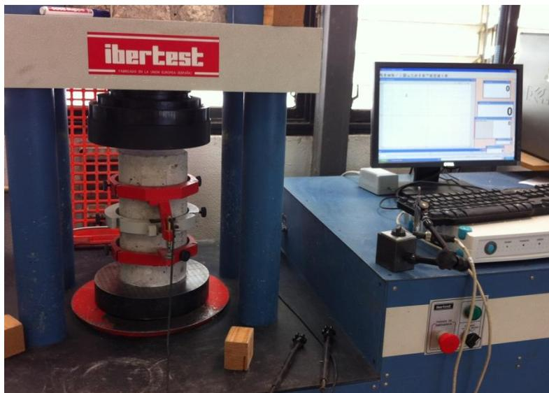
Imagen 70. Determinación del módulo de elasticidad a compresión
