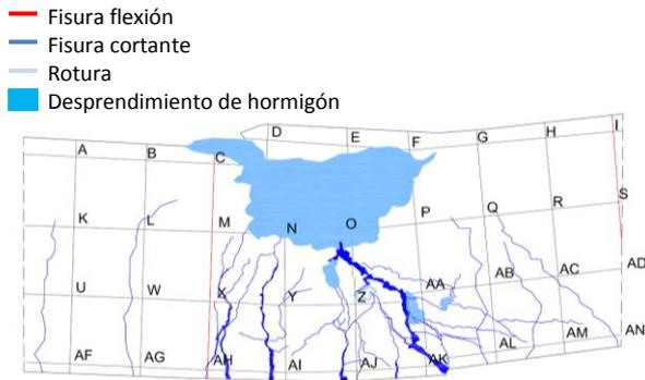
Figura 44. Rotura viga V.1.2
