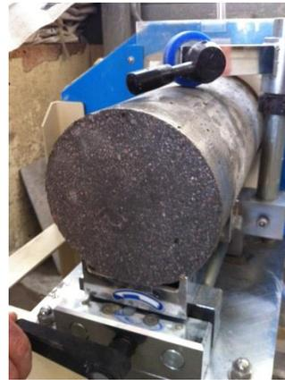
Imagen 67. Refrentado probetas cilíndricas
