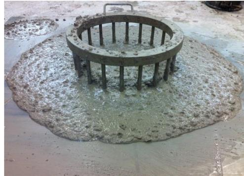
Imagen 54. Resultado de ensayo de anillo J
