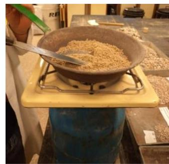
Imagen 38. Secado del árido
