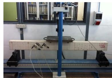
Imagen 74. Ensayo a flexión en 4 puntos
