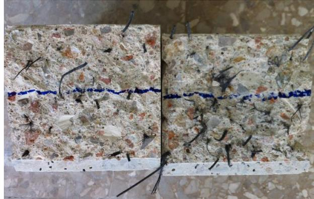
Imagen 116 cantidad de fibras probetas prismáticas
