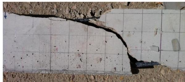
Imagen 122. Rotura viga V.1.1
