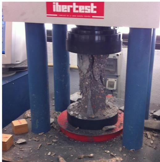
Imagen 71. Ensayo de compresión en probetas cilíndricas
