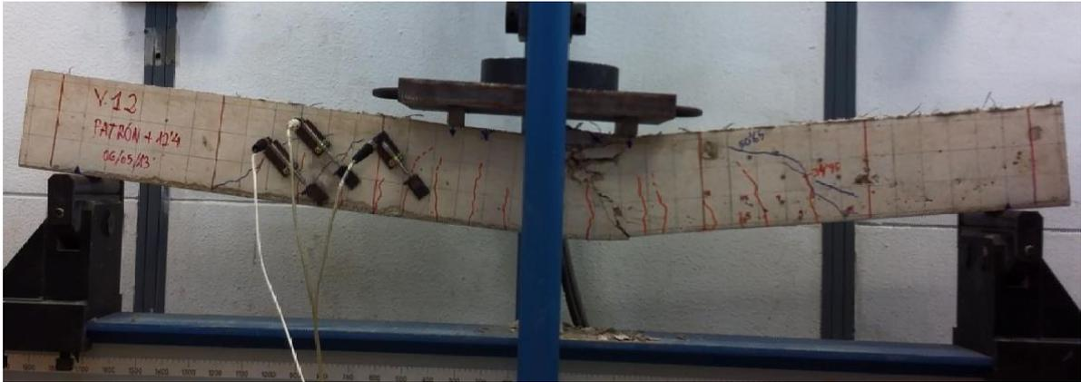
Imagen 131. Viga V.1.2 tras ensayo flexión a 4 puntos
