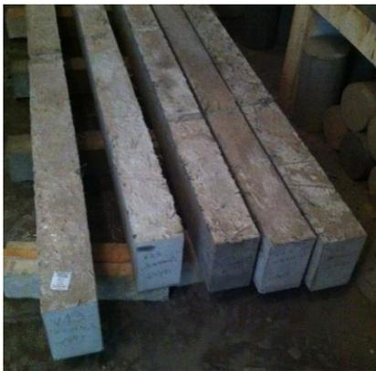
Imagen 64. Vigas en cámara de curado
