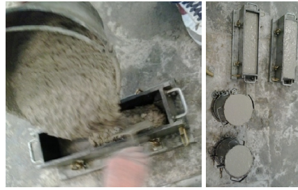
Hormigonado de probetas
