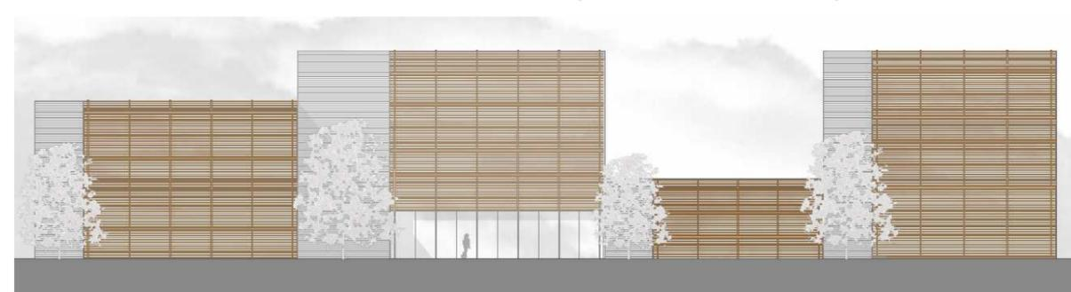
Mecanismos de control solar fachada este (correderas con lamas verticales)
