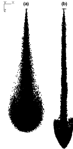
Figura 3.14. Comparación cualitativa de los chorros calculados con el modelo de turbulencia k - \epsilon modificado C\epsilon_1=1.51 : (a) con y (b) sin, el sub-modelo de dispersión turbulenta de las gotas ( t = 2ms ).
