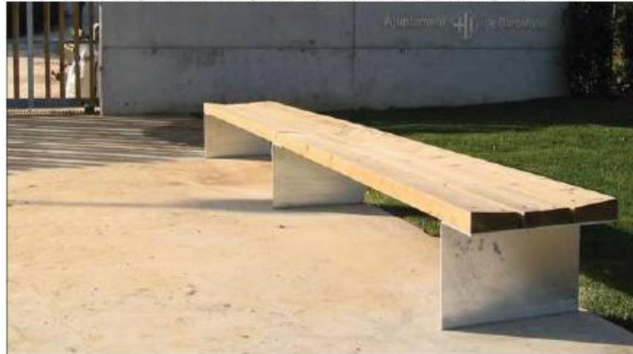
Estructura de plancha doblada de acero de 6 mm con protección antioxidante y pintada en polvo. Asiento y respaldo de tablonetes de madera tropical maciza de 50/85 x 180 mm de sección y longitudes variables, con certificado FSC puro, acabada con aceite de dos componentes o lasur trípica.
