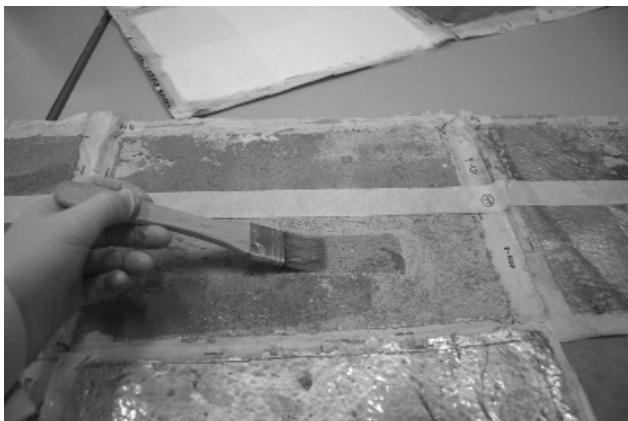
Figura 2. Aplicación de pre-consolidante Estel 1000® sobre reverso de probeta
