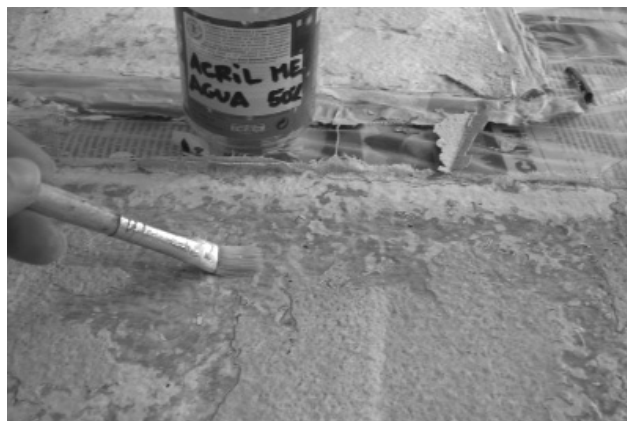
Figura 3. Aplicación de pre-consolidante Acril ME® 50% (fase 2) sobre reverso
