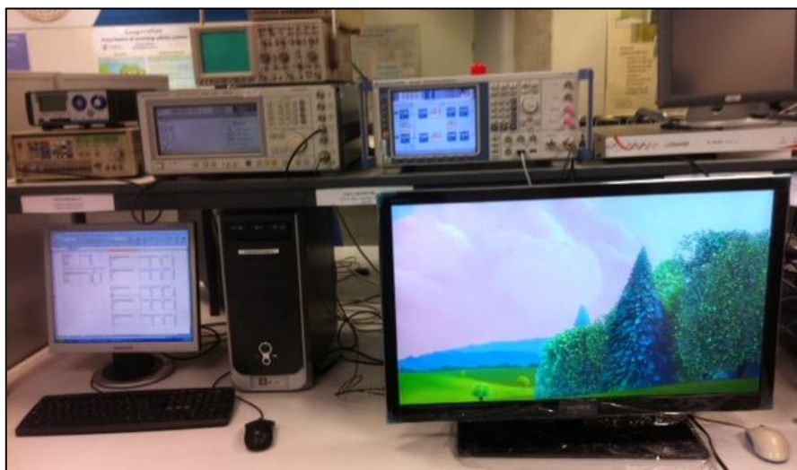
Ilustración 77: Montaje experimental utilizado para el proceso de medida con DVB-T2
