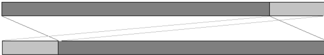
Ilustración 38: Funcionamiento del entrelazado para un Símbolo i y Segmento k
