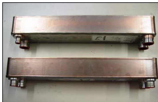
Figura 2.12 Intercambiadores de calor SWEP B80 de 26 placas instalados en el prototipo 1.
