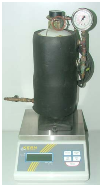
Figura 2.8 Balanza y depósito de almacenamiento de propano para la dosificación de refrigerante realizada en los estudios de carga con propano.
