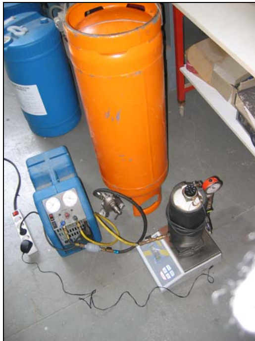
Figura 3.15 Detalle del procedimiento de llenado del recipiente de almacenamiento de refrigerante para su posterior introducción en la unidad de ensayos
