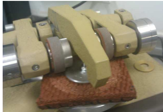
Figuras 17 y 18. Abrasímetro TABER y muelas abrasivas T18
