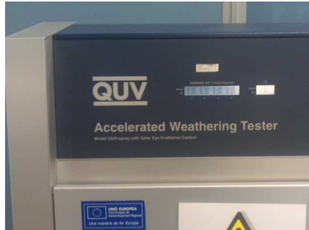
Figuras 13 y 14. Cámara de envejecimiento artificial por radiación UV
