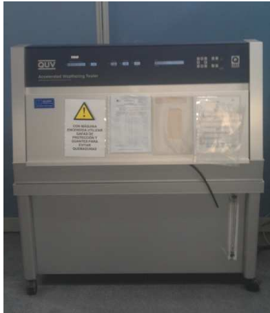
Figuras 13 y 14. Cámara de envejecimiento artificial por radiación UV
