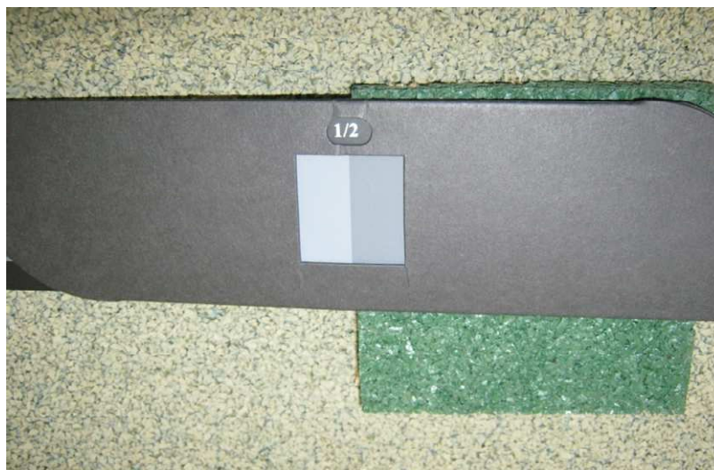
Figura 7. Ensayo de solidez de color
