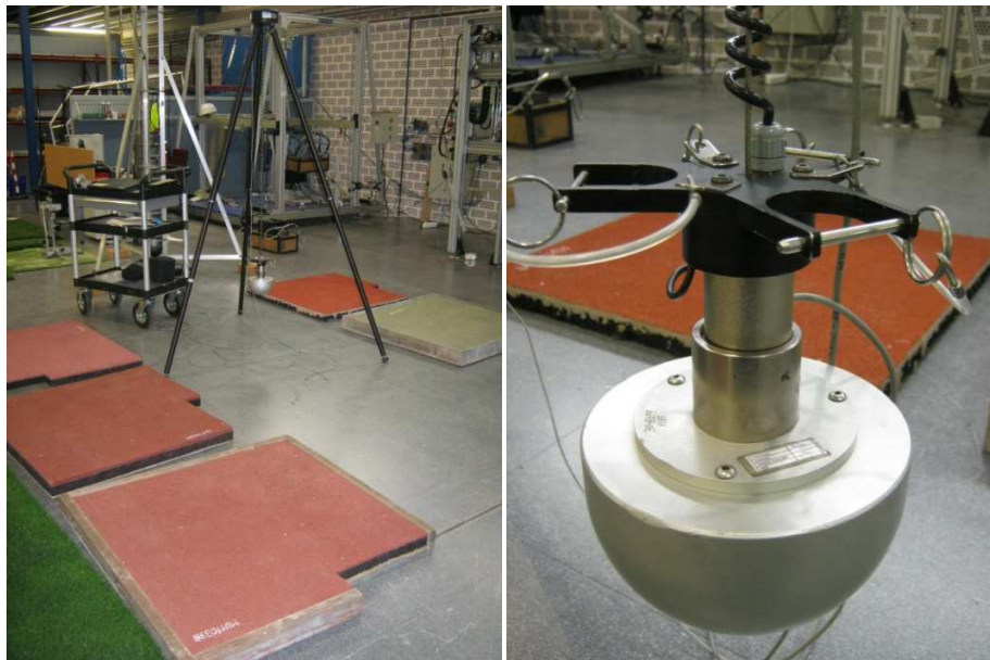
Figuras 5 y 6. Preparación de ensayos de determinación de altura crítica de caída
