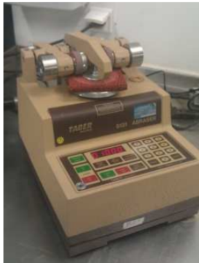
Figuras 17 y 18. Abrasímetro TABER y muelas abrasivas T18
