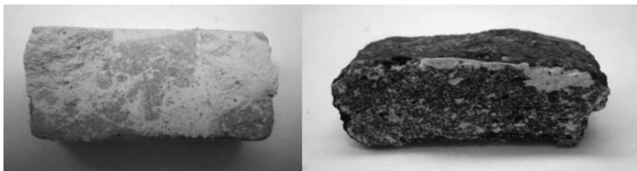
Figura 4. Muestra de azulejería y cerámica de la Edad del Bronce después de eliminar la masilla (sin estrato intermedio + Polyfilla Interiores®)
