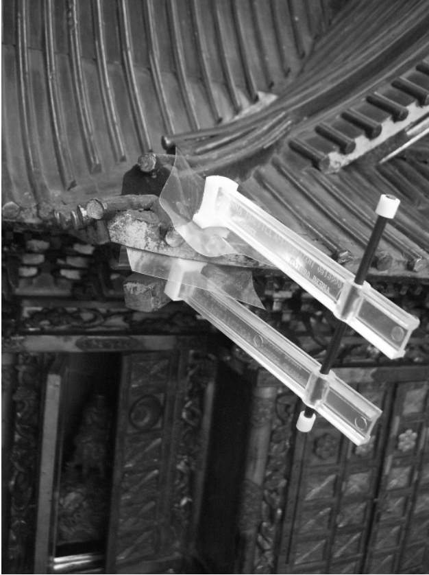
Figura 10. Fijación de una parte desprendida del tejado del kamidana con un minisargento de PVC. (Fotografía: Ya Hui Liu Zhou; Museum für Völkerkunde, Viena, 2008)
