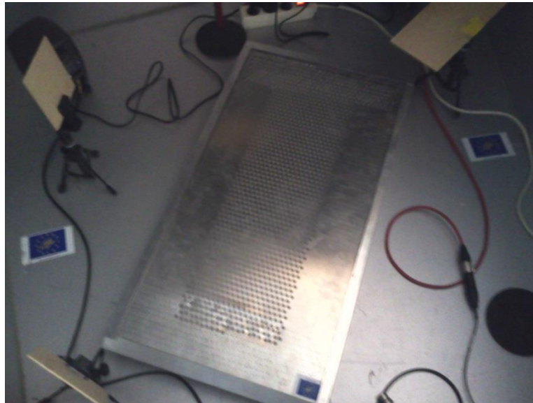
Fig.26. Montaje para la medida del coeficiente de absorción de las plancha con el diseño 2
