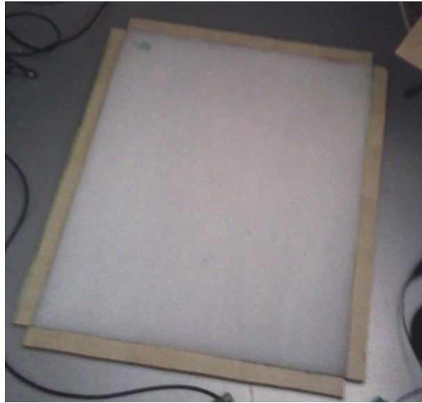
Fig.17. Montaje para medir el coeficiente de absorción del absorbente
