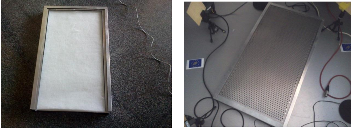
Fig.24. Montaje para la medida del coeficiente de absorción de las placas perforadas
