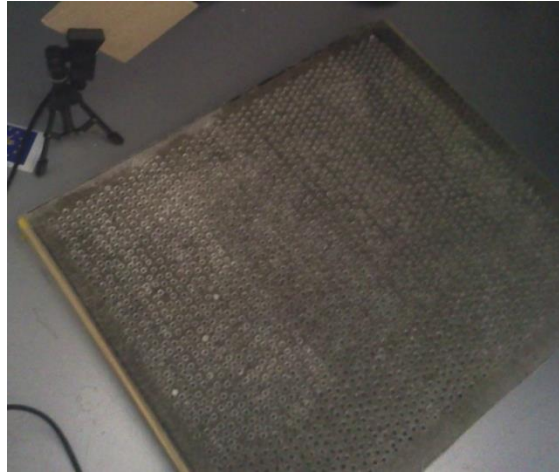
Fig.29. Montaje del Green Composite perforado en Cámara reverberante
