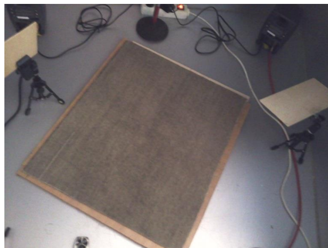
Fig.20. Montaje para medir el coeficiente de absorción del Green Composite con plenum de 2cm.
