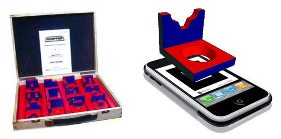
Para poder utilizar estos modelos de RA, son necesarios los siguientes elementos: Una marca, un programa de visualización, un fichero para cada una de las piezas y una cámara web. Todos estos elementos (menos la cámara) están incluidos dentro del material digital del libro.
