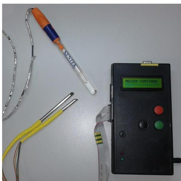
**FIGURA 1.** Equipo potenciométrico.
