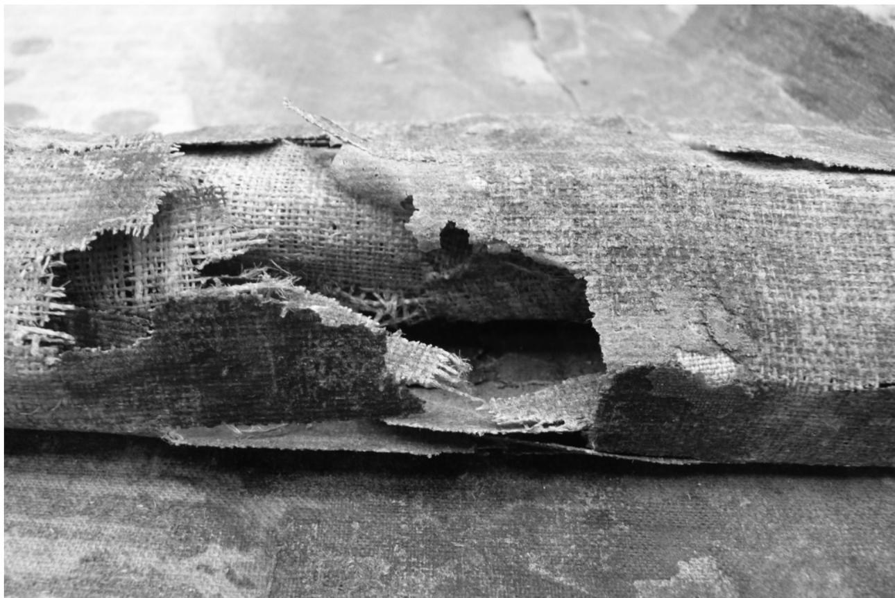
Figura 6. Degradación física y pérdida de resistencia mecánica de los materiales de entelado de una pintura sobre lienzo
