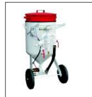
Equipos de chorro de 60 y 100 litros de capacidad.
