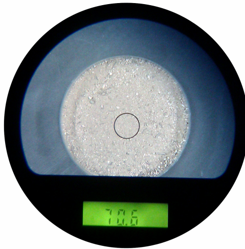
Figura 4.7: Muestra de suelo observada a través del colorímetro
