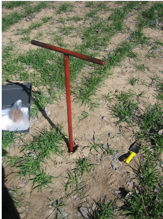
Figura 3.2: Recolección de muestras de suelo en campo con barrena
