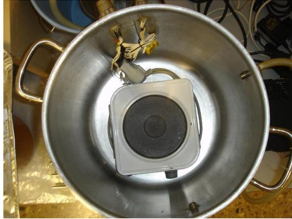
**Figura 1.3.** Placa calefactora eléctrica colocada dentro de la cámara de vacío.
