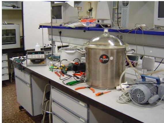
**Figura 1.1.** Fotografías de la cámara de vacío donde se introduce el recipiente de fritura con el aceite y algunos elementos adicionales.
