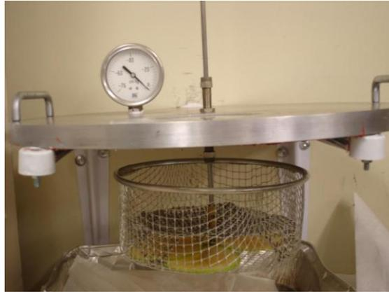
**Figura 1.7.** La tapa y el portamuestras con láminas de manzana.
