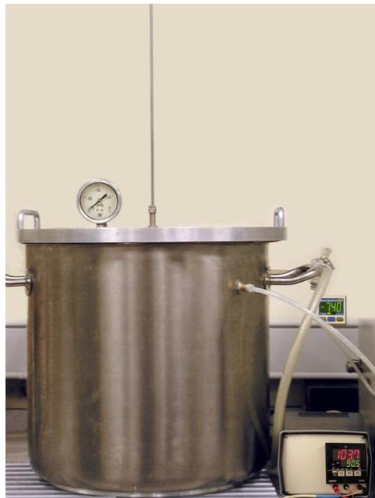
**Figura 1.8.** Equipo de fritura al vacío durante el proceso.
