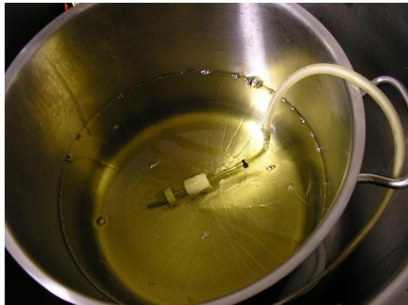
**Figura 1.4.** Recipiente de fritura, con aceite y el sensor de temperatura, colocada dentro de la cámara de vacío.
