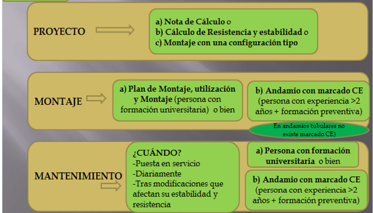
Ilustración 10. Requisitos de los andamios prefabricados.
