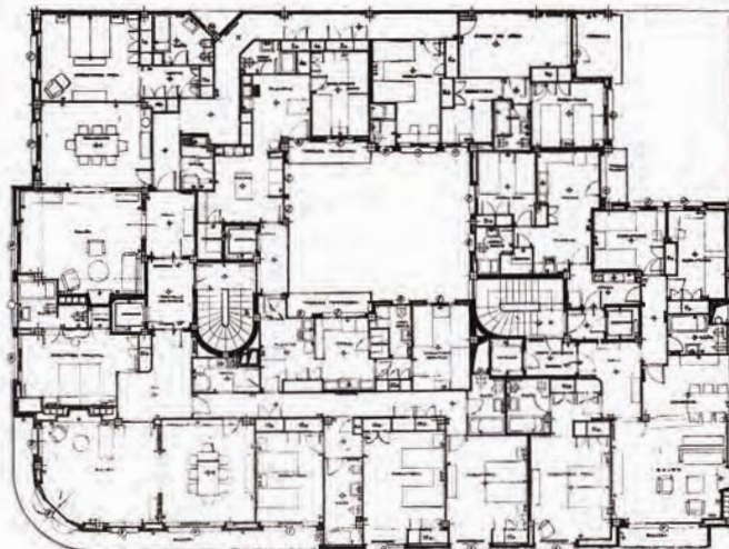
Planta general de pisos. Se compone de tres viviendas por planta, servidas las dos de la izquierda por una escalera y la de la derecha por otra.
