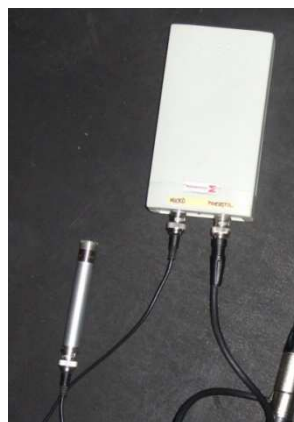
Figura 20. Micrófono de condensador de incidencia aleatoria y preamplificador
