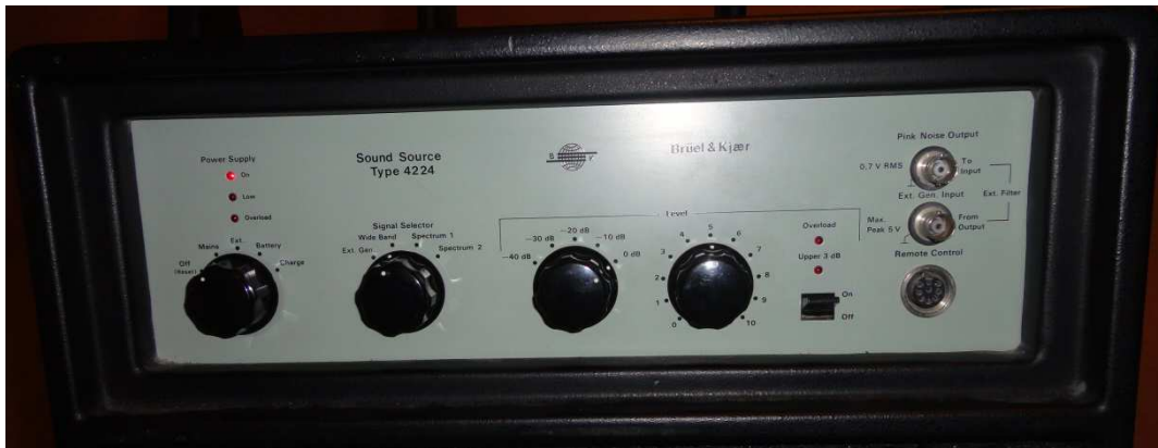
Figura 92. Configuración de la fuente sonora durante la medición del aislamiento
