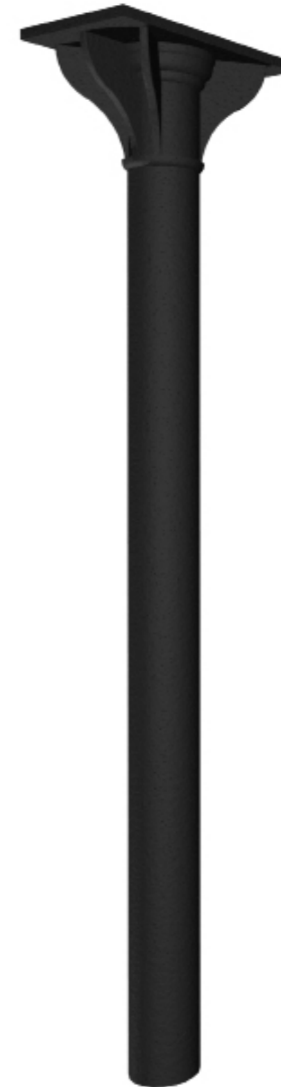
Vista 3D Pilar de fundición
