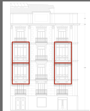
Hueco del mirador con dintel de madera y fachada de fábrica de ladrillo macizo de 1ª
