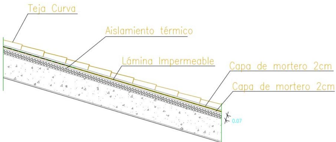
Fig.35 – Detalle constructivo de la cubierta con forjado inclinado con la solución propuesta de PUR.
