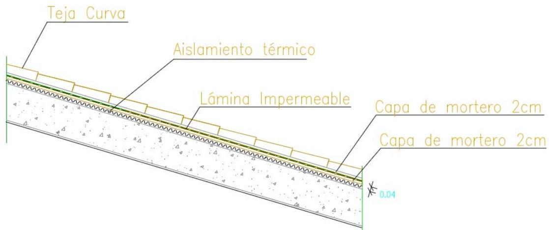
Fig.34 – Detalle constructivo de la cubierta con forjado inclinado según proyecto.
