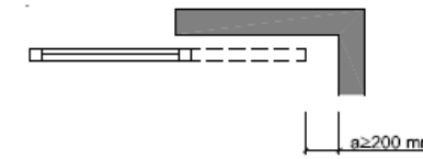
Figura 2.1 Holgura para evitar atrapamientos
