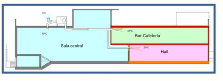
El volumen de la sala es de 860 m<sup>3</sup>, según RITE se necesitan 2.390,4 m<sup>3</sup>/h siendo el número de renovaciones para la sala de 2,78 por hora. Cada 20 minutos se introducirá aire del exterior y se extraerá el viciado, tomando el resto del interior de la sala principal.
