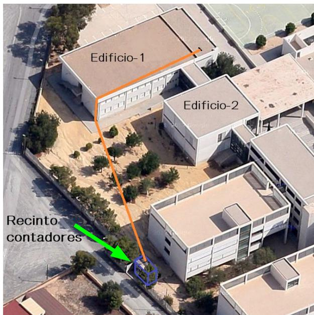
Figura 10.7. Trazado del cableado trifásico.
