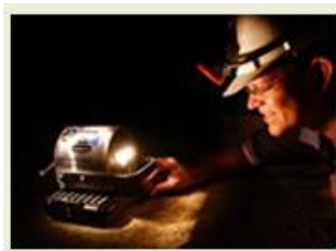
Figura 1.4 Robot miniatura que realiza operaciones de rescate en desastres ocurridos en las minas.
