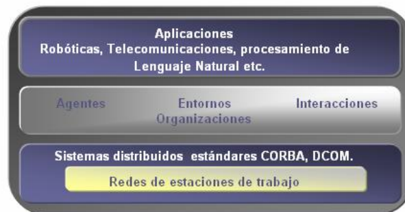
Figura 2.8. Arquitectura en capas en un SMA modelado con Vowel.
