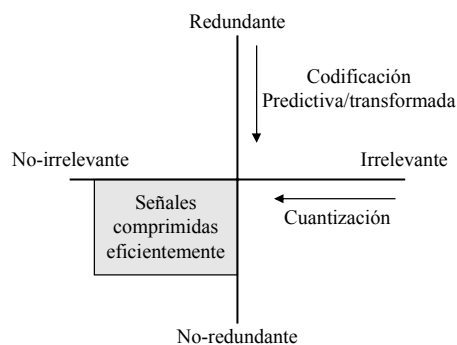
Figura 2.7. Diagrama de Schouten, que muestra la aplicación de algunas técnicas para la reducción de redundancia e irrelevancia de las señales digitales.
