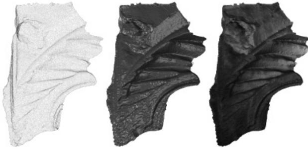
Figura 5. Nube puntos, malla y texturizado del las nervaduras torsas
