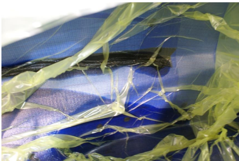
Figura 6-21 Frente de avance de la resina.
