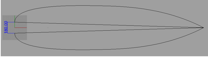
Figura 5-9 Abertura delantera para el perfil 0020-65.
