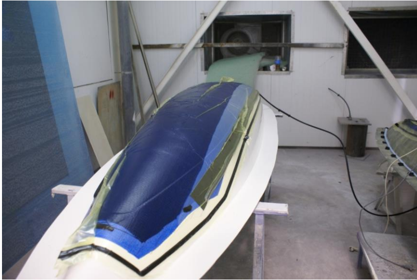
Figura 6-24 Tapa del prototipo en el horno mientras cura la resina.
