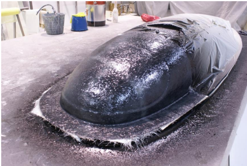
Figura 6-10 Colocación de la fibra de vidrio para la creación del molde.
