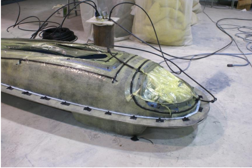
Figura 6-18 Vista general del molde mientras se realiza la infusión.
