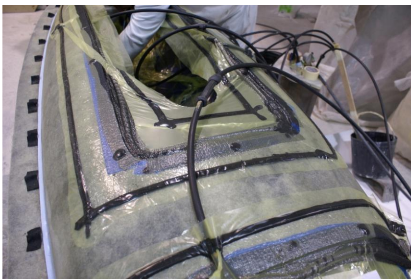
Figura 6-17 Vista general de los tubos para la infusión.
