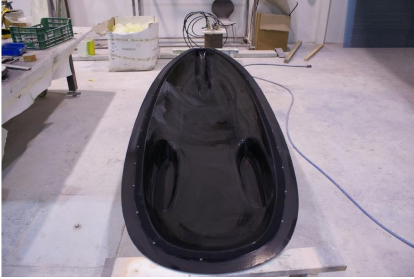
Figura 6-11 Interior de la parte inferior del molde.
