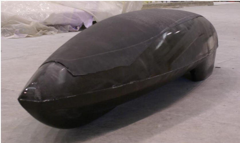
Figura 6-26 Carrocería desmoldeada, se puede apreciar la tapa superior sin recortar.
