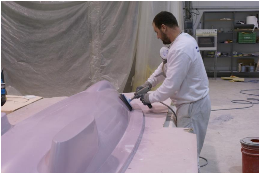
Figura 6-7 Pulido de la imprimación.
