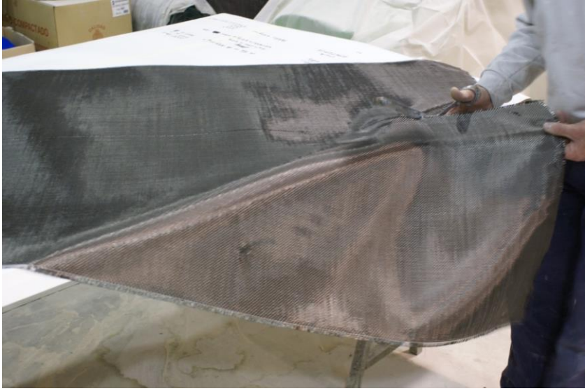
Figura 6-14 Corte de la tela de carbono tras hacer el patronaje.
