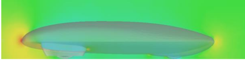
Figura 2-5 Punto de estancamiento en el vehículo del IDF.
