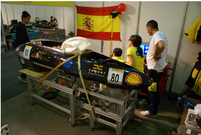
Figura 7-7 Vehículo sobre banco de potencia a la rueda.
