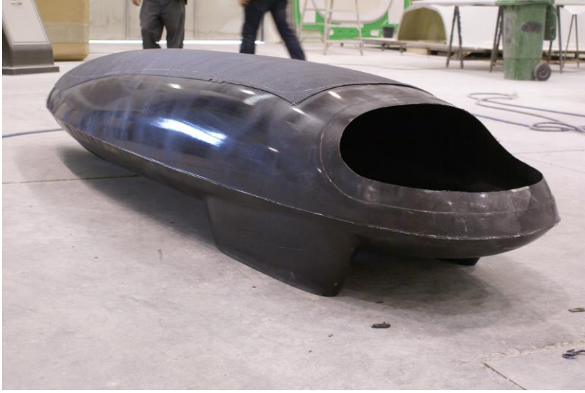
Figura 6-25 Carrocería desmoldeada a falta de barnizado de protección.
