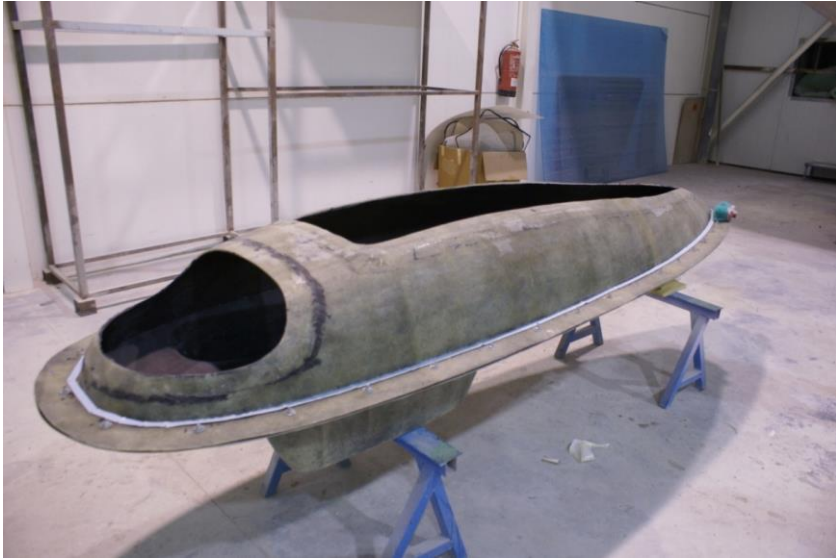
Figura 6-13 Vista general del molde acabado.
