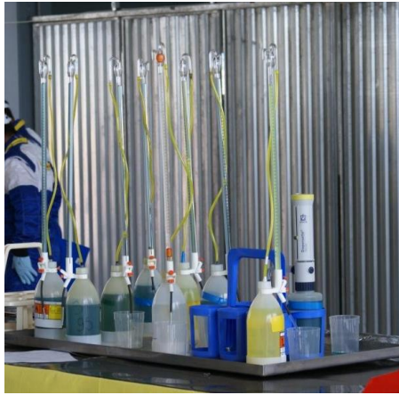
Figura 3-1 Sistemas de medición por volumen para combustibles líquidos (Shell Eco-Marathon Lausitz 2011).
