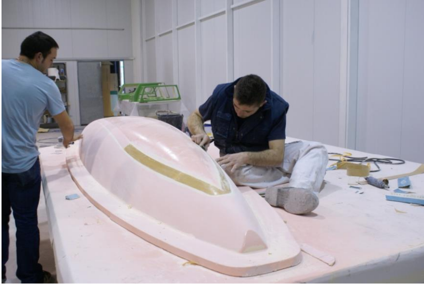
Figura 6-6 Ajuste de bordes con cera calibrada.
