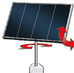
Figura 11.2. Sistema de seguimiento por dos ejes.
