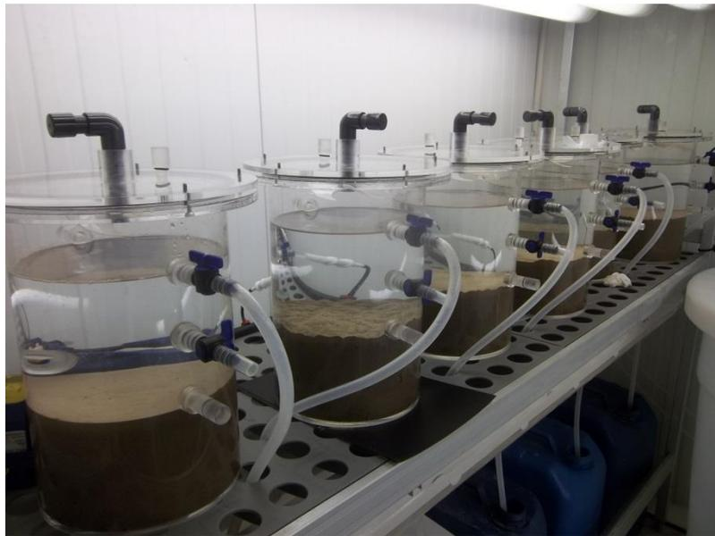
Figura 3.3: Instalación de las cámaras bentónicas durante la etapa de aclimatación y siembra
