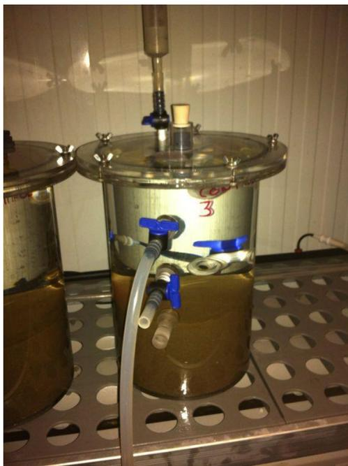
*Figura 3.5: Muestra una cámara de incubación durante el ensayo, donde se puede observar la jeringa instalada en la tapa a través de la cual se restituye el volumen de agua extraído en cada muestreo.*
