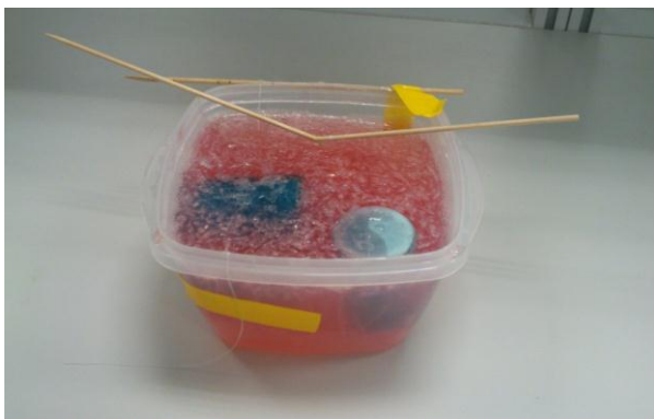
Figura 3.9 Segunda phantom de 20 kPa, con inclusiones de 50 y 100 kPa.
