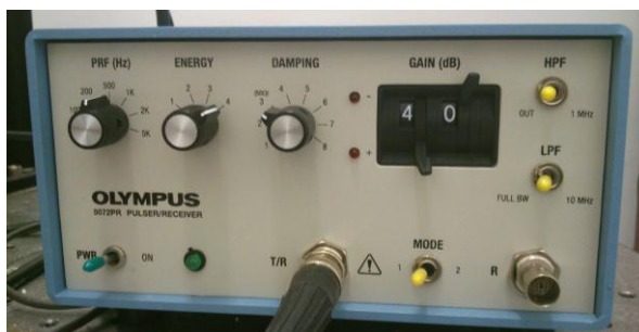
Figura 3.23. Generador/receptor de pulsos Olympus 5072PR.
