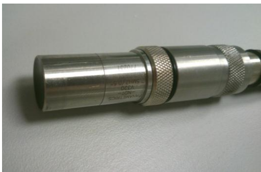
Figura 3.21. Transductor focalizado V320 de Panametrics.
