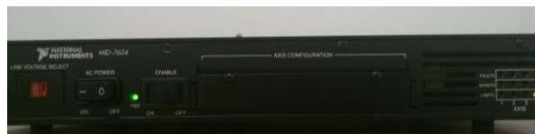
Figura 3.19. Motor paso a paso National Instruments MID- 7604. Permite hasta 4 ejes.
