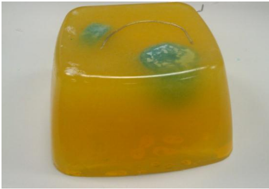
Figura 3.5 Primer phantom realizado de 20kPa.
