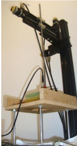
Figura 4.1 Segundo phantom multicapa, de 100, 50 y 20 Kpa.
